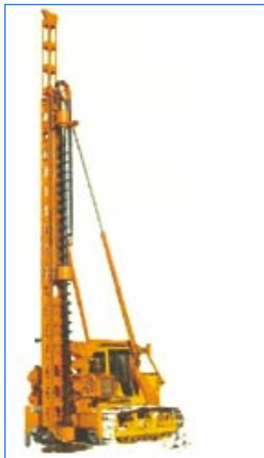
Бурильно сваебойная машина предназначена для бурения скважин в грунтовых условиях крайнего севера, песчаных грунтах, забивания в них свай при строительстве свайных фундаментов зданий и сооружений, а также установки деревянных и железобетонных опор, металлических труб при строительстве линий электропередачи и связи.
